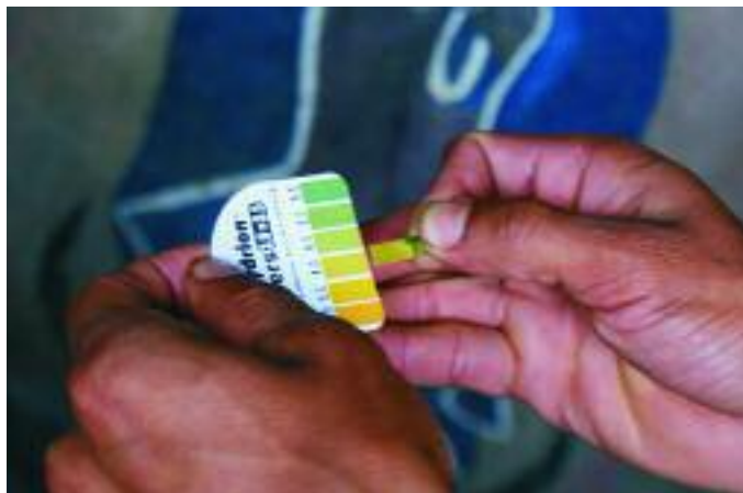
Der Lakmestest beim Fermentieren des Kaffees - der pH-Wert wird bestimmt. Optimal ist 4,0 Foto: rk
